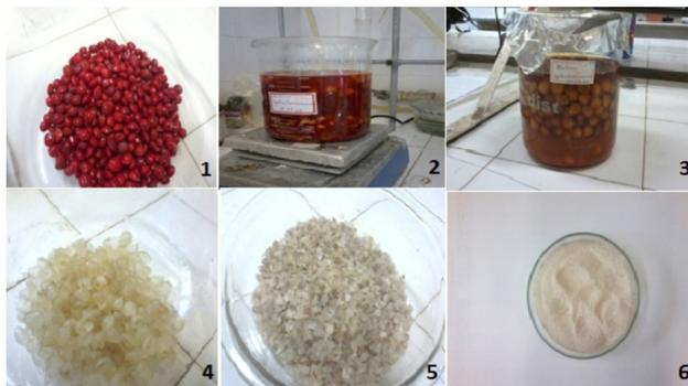
Etapas de obtenção da galactomanana: sementes (1), aquecimento em água fervente (2), intumescimento por 24 horas (3), endospermas após separação manual (4), secagem em acetona PA (5) e obtenção do produto final após trituração (6).
