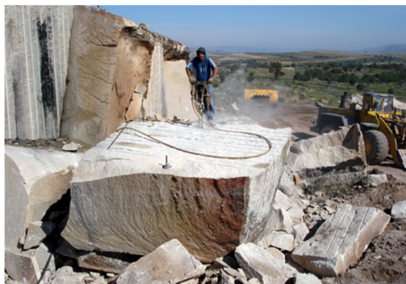
As pedras são cortadas em blocos, produzindo resíduos
